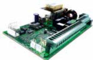
Плата управления блокиратора JE275 управление макс. 1 блокиратором J355 М30-Р1
