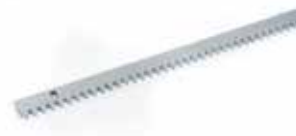
Оцинкованная зубчатая рейка 30x8 мод. 4 с приварными креплениями (в упаковке 4 м)
