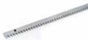
Оцинкованная зубчатая рейка 30x12 мод. 4 с приварными креплениями (в упаковке 4 м)
